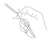
先ほど溶着した側と反対側(ヘッドボックス側)から古いコードを引き出します。完全に入れ替わるまで引き出してください。引き出したコードは、マルチポールより 20cm 程度長くしてカットします。
