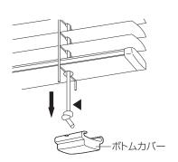
4 ボトムカバー側から引き出したコードと新しい コードを溶着します。まず、ライターでコードの先端を2本同時にあぶります。
